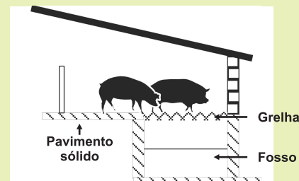
Fig. 3 - Piso parcialmente em grelha
